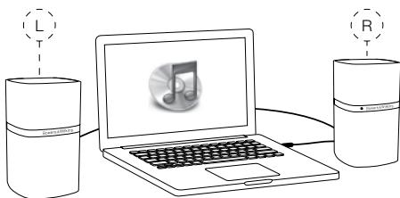
Die beiden MM-1-Lautsprechereinheiten sind links und rechts neben einem Computermonitor zu positionieren. Der aktive Lautsprecher sollte rechts, der Slave-Lautsprecher links stehen. Stellen Sie die Lautsprecher nicht zu weit auseinander, wenn Sie nahe am Monitor sitzen. Das von den beiden Lautsprechern und dem Kopf des Hörers gebildete Dreieck sollte möglichst gleichseitig sein. Oben ist die MM-1-Lautsprecherpositionierung dargestellt.
