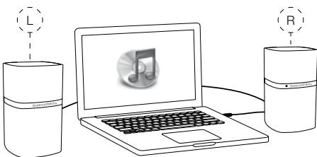
As duas colunas MM-1 destinam-se a ser colocada na secretária, de cada um dos lados do monitor. A coluna activa deve ficar à direita do monitor e a coluna satélite à esquerda. Não coloque as colunas demasiado afastadas se estiver muito próximo do monitor. O triângulo formado pelas duas colunas e pela cabeça do utilizador deve ser aproximadamente equilátero. A posição das colunas MM-1 é mostrada acima.
