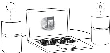
Oba reproduktory MM-1 jsou navrženy pro umístění na desku stolu, každý po jedné straně monitoru. Napájený reproduktor může být po pravé a přidružený po levé ruce. Sedíte-li blízko monitoru, neumisťujte reproduktory příliš daleko od sebe. Oba reproduktory by s posluchačem měly tvorit zhruba rovnostranný trojúhelník. Rozmístění reproduktoru MM-1 znázorňuje obrázek nahoře.
