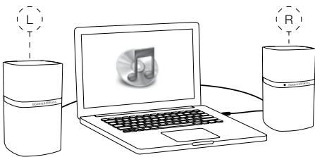
De beide MM-1 luidsprekers zijn bedoeld voor opstelling aan weerszijden van een computer monitor: de actieve luidspreker aan de rechter zijde en de Slave Speaker aan de linker zijde. Plaats de luidsprekers niet te ver uit elkaar wanneer u dicht bij de monitor zit. Zorg ervoor dat de afstanden van u tot de luidsprekers en de luidsprekers onderling ongeveer gelijk zijn. Zie de opstelling hierboven.
