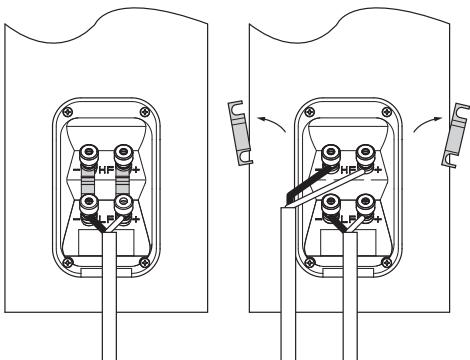
Todas las conexiones deberían realizarse con el equipo desconectado.
