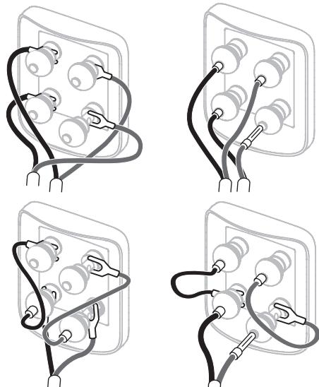
Il y a deux paires de prises à l'arrière de chaque enceinte, afin de permettre le bi-câblage (voir schéma ci-dessus). Pour une liaison conventionnelle avec un seul câble, utilisez les câbles fournis permettant de relier les prises de même polarité sur l'enceinte.
