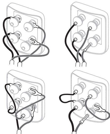
Sul retro del diffusore sono presenti due coppie di morsetti che consentono il collegamento in bi-wiring (figure in alto). Per le connessioni tramite un unico cavo, vengono forniti dei cavetti con terminazioni a banana per unire tra loro con un ponticello i morsetti della stessa polarità.
