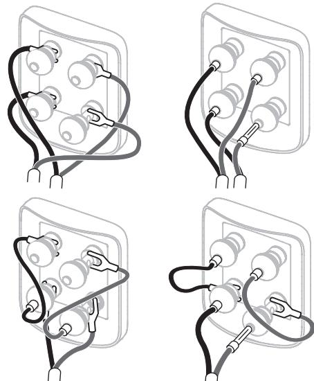
各スピーカーの背面には、バイワイヤリングが可能な2組の端子があります(トップ)。従来のシングル・ワイヤ接続を行う場合は、付属のリンク・ワイヤで同じ極性の端子をつないでください。
