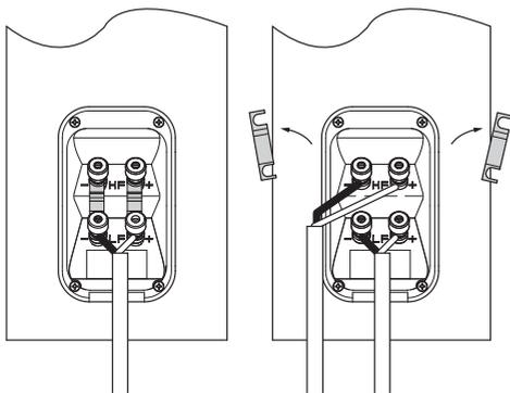
Все подключения делаются только при выключенном оборудовании.
