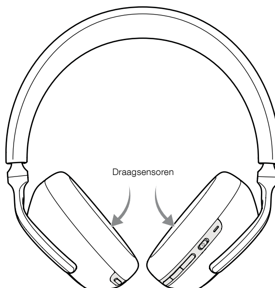
Figuur 4 Locatie van de draagsensoren
